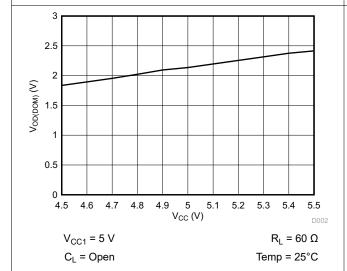
Figure 6-11. V<sub>OD(DOM)</sub> Over V<sub>CC</sub>
